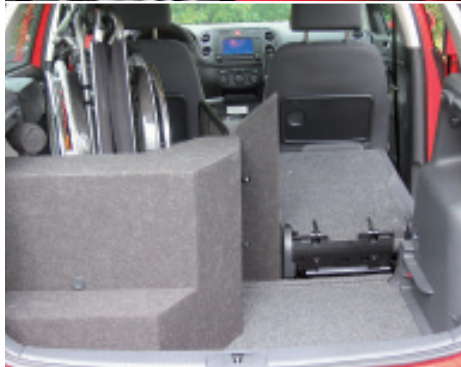
EDAG Rollstuhl- Ladehilfe VW Golf Plus EDAG wheelchair loading- help system EDAG Chaise roulante – Aide au chargement
