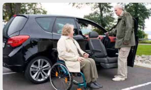
03 Der Turny. Der absenkbare Drehsitz für alle Vans oder SUVs.
