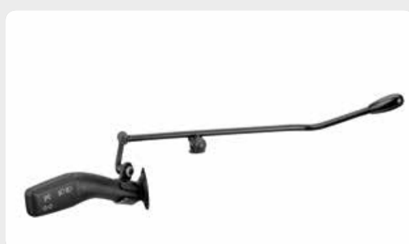
02 Die Wischer oder Blinkerhebelverlegung über Zusatzhebel. Aktivierung der Wischer- und Waschfunktionen bzw. von Blinker und Fernlicht.
