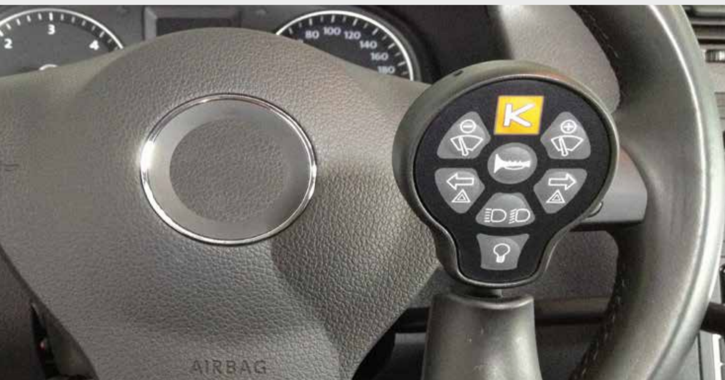
01 Der Telekommander. Bis zu 12 Fahrzeugfunktionen (Wischer, Blinker, Hupe, Fernlicht usw.) am Lenkradknopf sicher im Griff.
