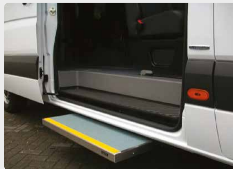
06 Trittstufen. Gewährleisten die Sicherheit ihrer Passagiere. Einfache und komfortable Bedienung.
