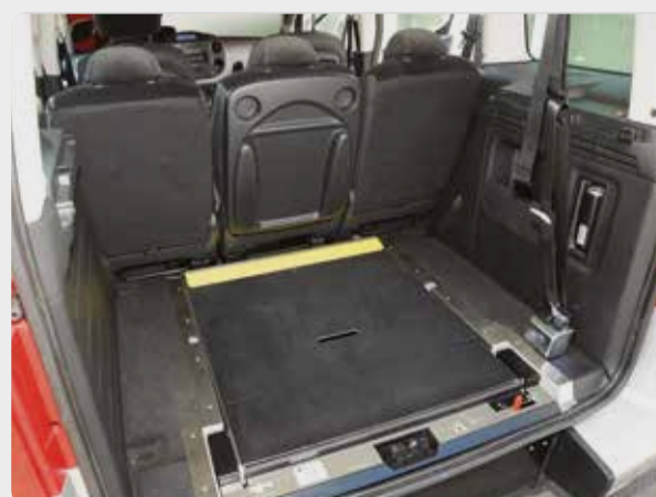
Die „FLEX-Rampe“. Die FLEX-Rampe in den Absenkfahrzeugen ermöglicht Ihnen die Nutzung des Kofferraumes ohne Einschränkungen. Durch den speziellen Klappmechanismus wird die Unterseite der Rampe zur Oberseite des Kofferraumbodens.
