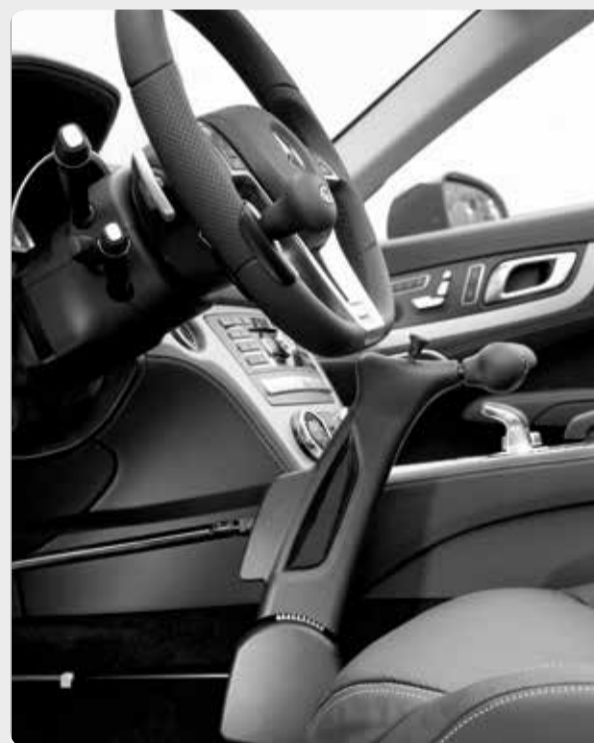
02 Die Veigel Classic Handbedienung. Geringer Kraftaufwand durch Gas-Drehfunktion.
